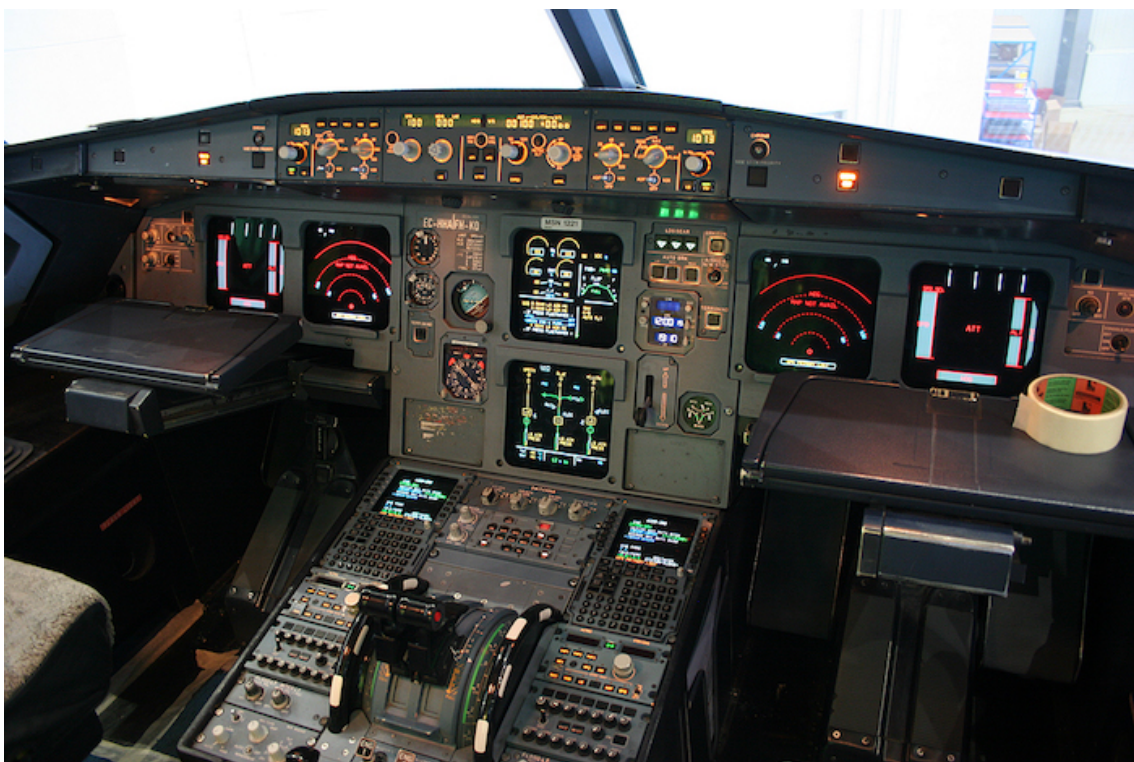
Fig. 2. Modern Cockpit of an Airbus A320 ( https://de.wikipedia.org/wiki/Airbus_A320 ) for two pilots
