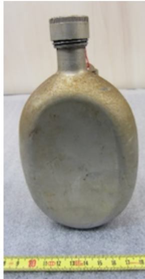
Fig. 4a. Dépôts exogènes sur une gourde.
