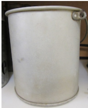
Fig. 4b. Piqûration généralisée sur un pot à lait.
