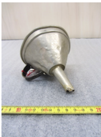
Fig. 3a. Marques de déformation sur un entonnoir.
