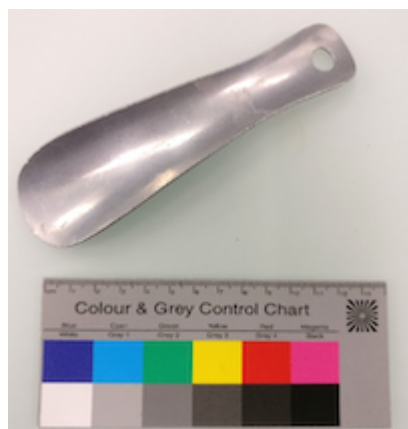
Fig. 6a. Chausse-pied en aluminium peu allié (famille 1XXX).
