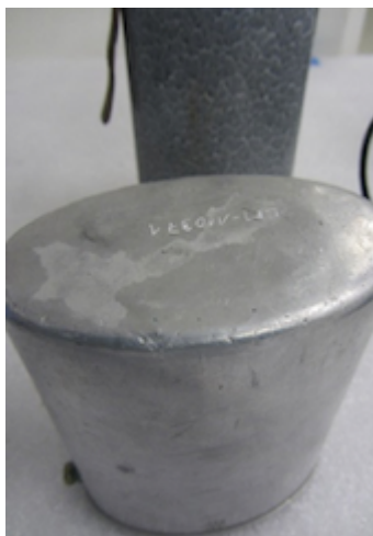
Fig. 3b. Marques d'usure et de ternissement sur une timbale de gourde.
