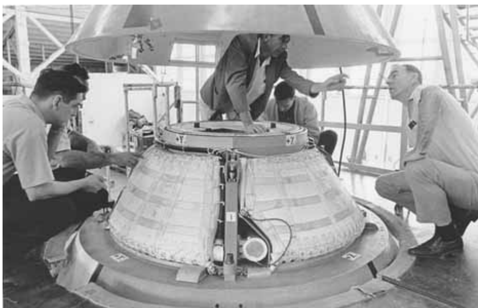
Figure 9 : Inspection de l'installation du Earth Landing System avant la fixation du couvercle de l'apex sur un véhicule d'essai Apollo
